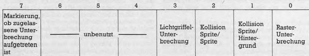
Bild 39. Das Interrupt-Latch-Register (53273 = \$d019) des VIC-II-Chip
